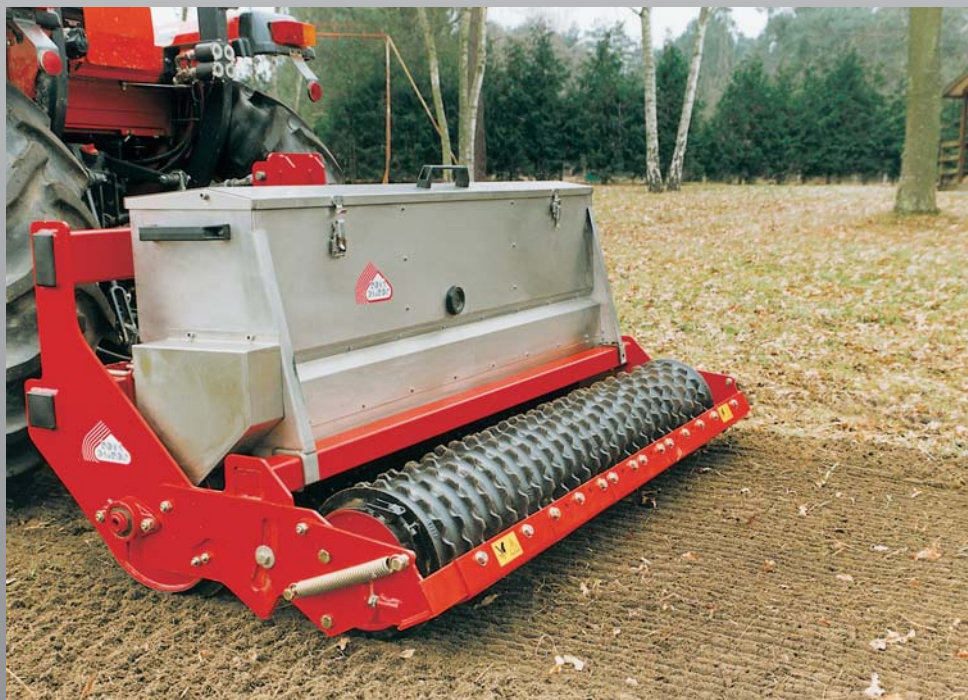
Le rouleau arrière enfouit à une profondeur contrôlée de 12 mm maximum
